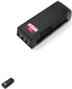
DESCRIZIONE PRODOTTO PoE injector per dispositivi di rete con standard 802.3af, tensione in uscita pari a 48 Vdc , distanza massima di trasmissione inferiore a 100 mt, velocità di trasmissione 10/100 Mbs , massima potenza erogata 15,4 W , alimentatore interna da 230Vac , dimensioni 150x56x45 mm
