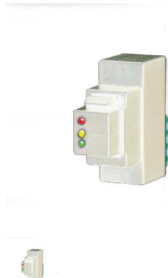
DESCRIZIONE PRODOTTO LETTORE DI PROSSIMITÀ UNIVERSALE DA INCASSO PER CENTRALI DOMUS816GSM, CHIAVE TAGDOM816; COLLEGAMENTO TRAMITE BUS RS485 A 4 FILI; INDIRIZZAMENTO MEDIANTE CODICE SERIALE UNIVOCO; POSSIBILITÀ DI ASSOCIARE 1 O PIÙ PAARZIALI; FUNZIONI UTENTE: INSERIMENTO, DISINSERIMENTO, VERIFICA IMPIANTO; L'INNOVATIVO SISTEMA DI COLLEGAMENTO TRAMITE RJ-45 CONSENTE IL MONTAGGIO SU TUTTE LE SERIE CIVILI ESISTENTI IN COMMERCIO E SU QUELLE FUTURE; COLORE BIANCO
