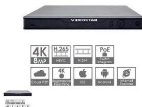
Network Video Recorder standalone 8 Canali; Gestione di 8 telecamere ad una risoluzione massima 8MP (Playback simultaneo di 4 telecamere IP a 4K), 1 Uscita VGA, 1 uscita HDMI, Compressione di registrazione H.264/H.265; 80 Mbps in registrazione, Pentaplex, 8 porte PoE (IEEE 802.3 af/at), 1 Ingresso / 1 Uscita Audio, 4 Ingressi / 1 Uscita allarme, Alloggio per 2 HDD Sata, Ethernet 10/100/1000 Mbps, CMS per la gestione di piu' NVR, Applicativo per Mobile (iPhone, iPad e Android).
